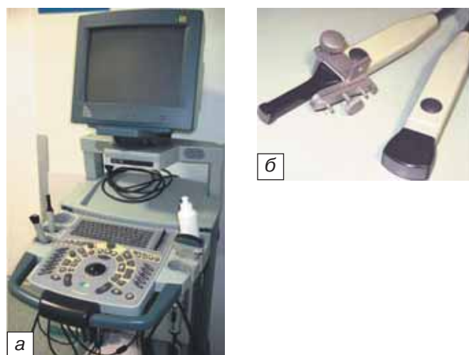
Рис. 1. Пример ультразвукового аппарата и датчиков для проведения интраоперационной сонографии: а — аппарат B-K Medical Pro Focus; б — конвексные датчики с частотой 5—10 МГц и 5—8 МГц для аппарата B-K Medical Pro Focus. Fig. 1. Sample of ultrasound device and transducers for intraoperative sonography: A - device B-K Medical Pro Focus, B — convex transducers with frequency 5 — 10 MHz and 5 — 8 MHz for device B-K Medical Pro Focus.
